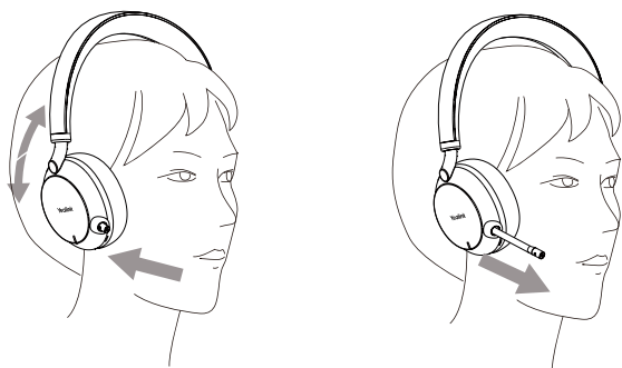
Perche de microphone cachée rétractable
